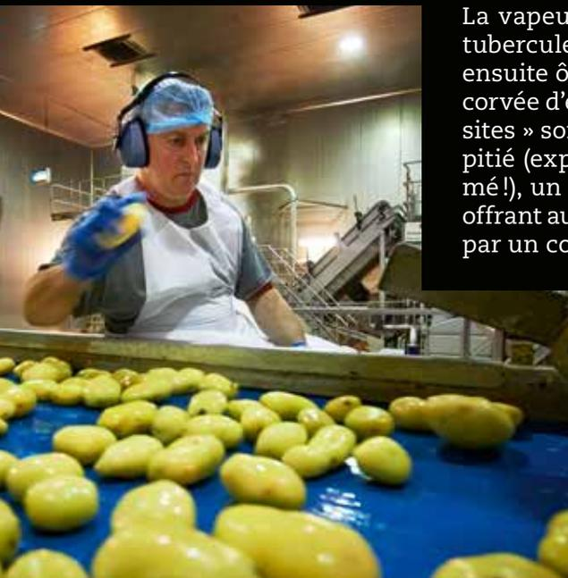
La vapeur décolle la peau des tubercules et des brosses vont ensuite ôter les pelures. Pas de corvée d'épluchage! Les « parasites » sont alors éliminés sans pitié (expulsés par air comprimé!), un trieur optique ne leur offrant aucune chance, secondé par un contrôle manuel.
