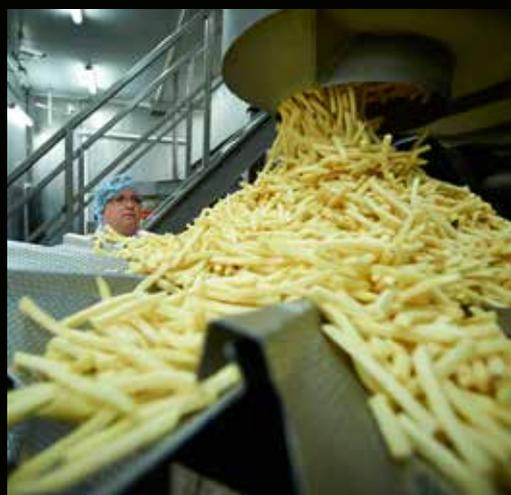
Les frites, après contrôle, sont pesées et réparties. Un calibrage assure l'adéquation du résultat au cahier des charges du client.
